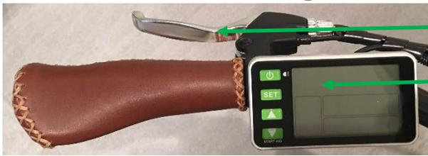
Bremshebel links mit Sensor
